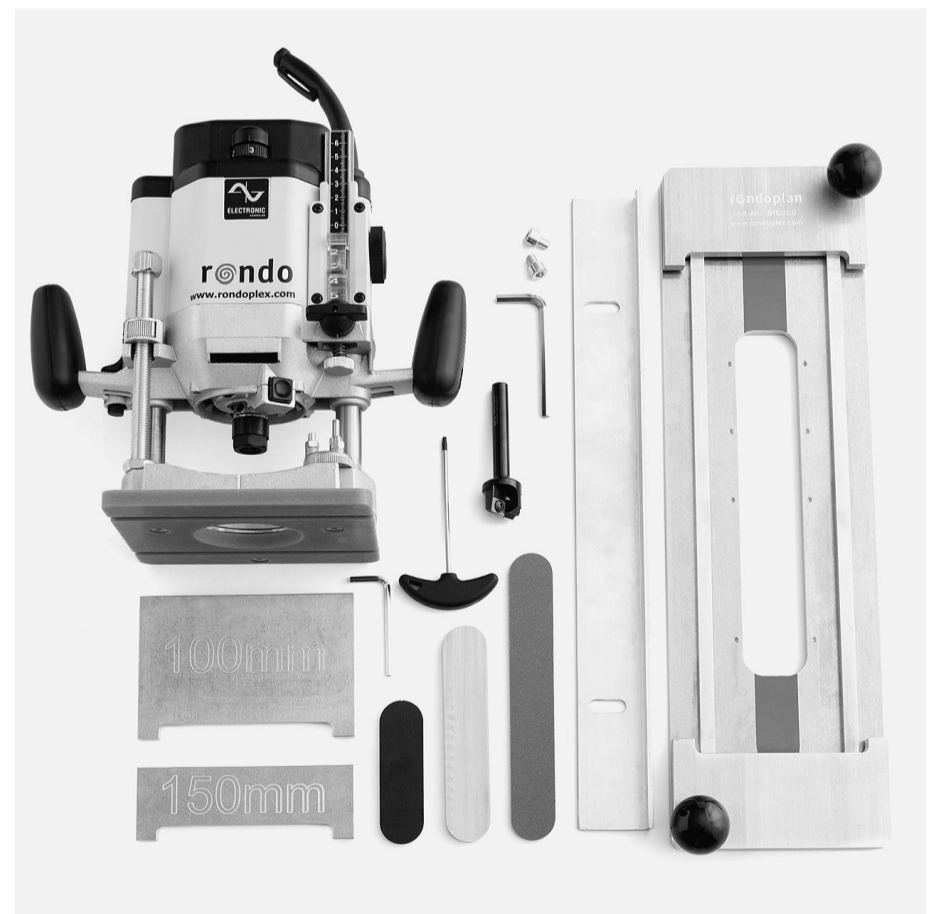
Eine mit speziell gefertigten rondo HM-Wendeplatten-Zylinderkopfböhrern bestückte Handoberfräse, die auf die entsprechende Bohrtiefe eingestellt ist, wird über der Schadstelle positioniert und die Bohrung (Sackloch) durchgeführt. Fotos: Herud
